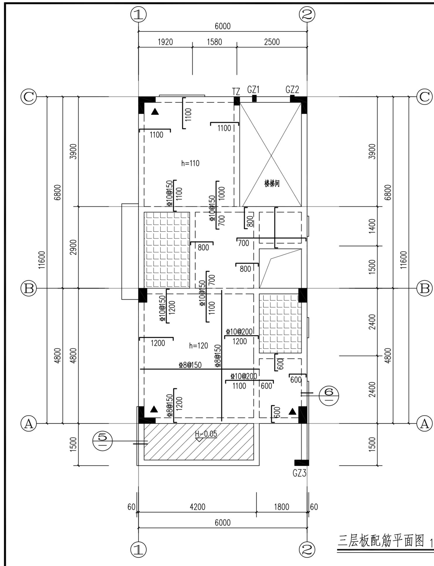
三层板配筋平面图 1:70
