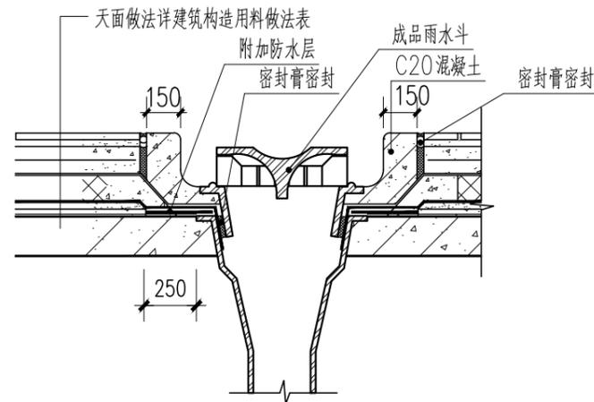
⑥ 雨水口防水构造 1:30
