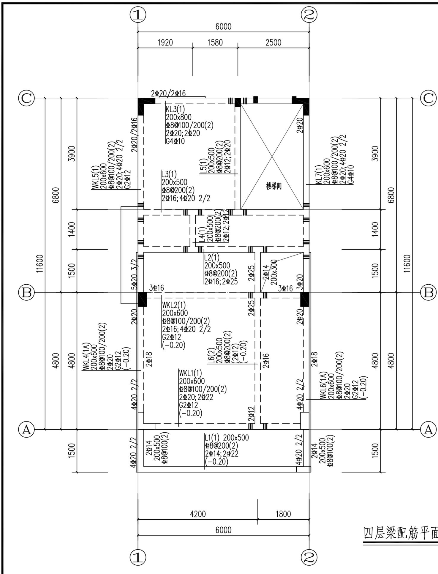
四层梁配筋平面图 1:70
