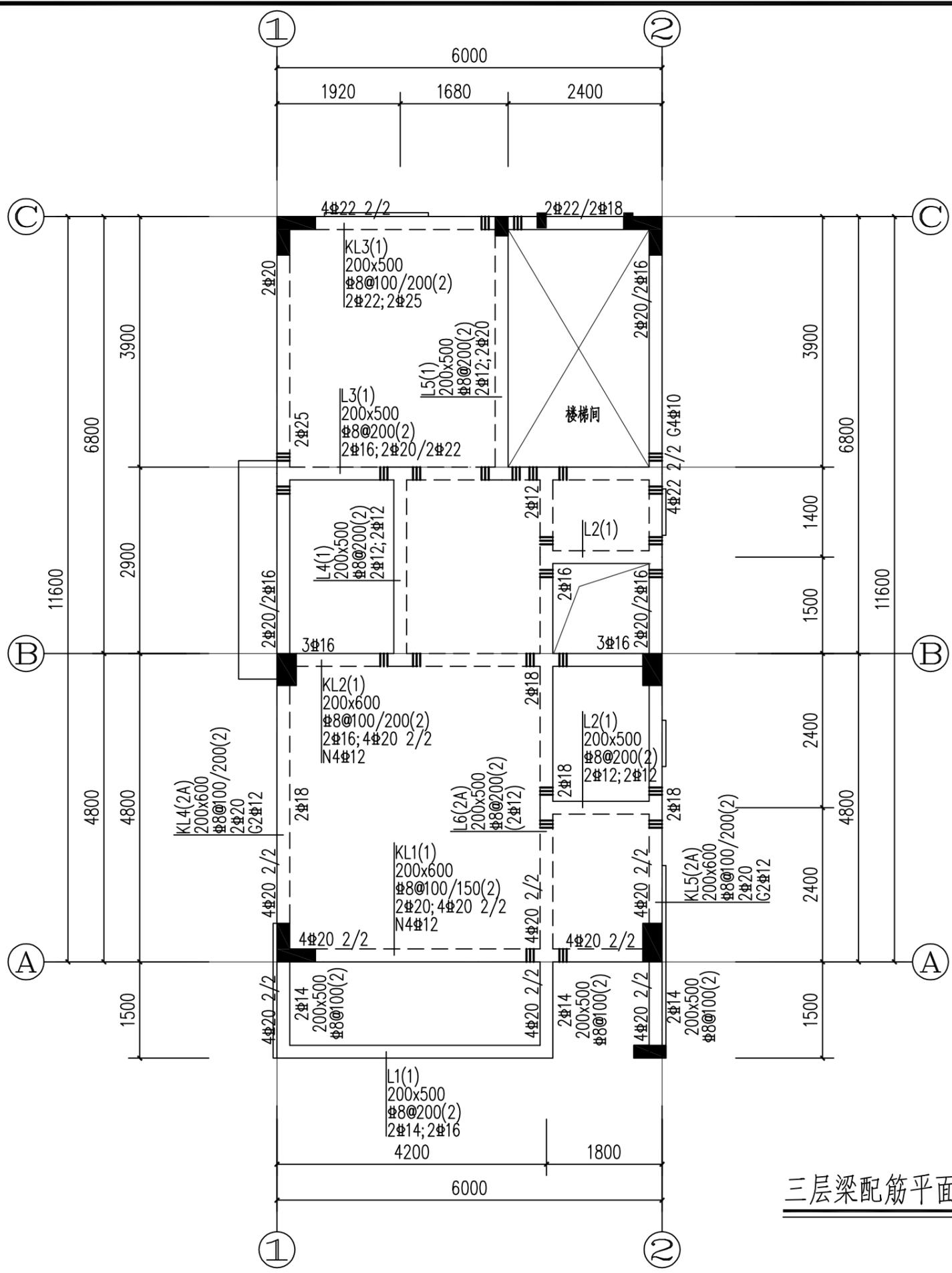
三层梁配筋平面图 1:70
