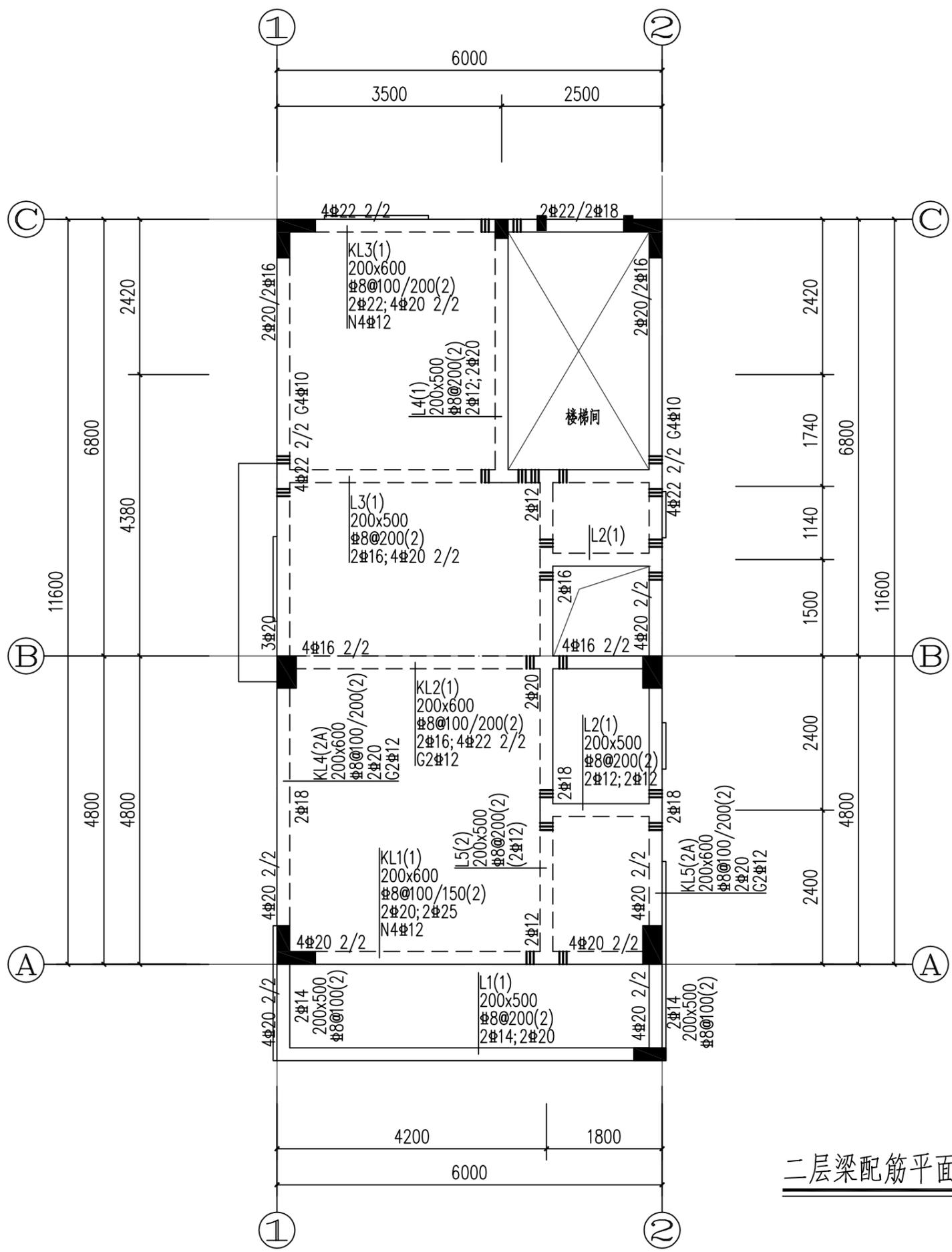
二层梁配筋平面图 1:70
