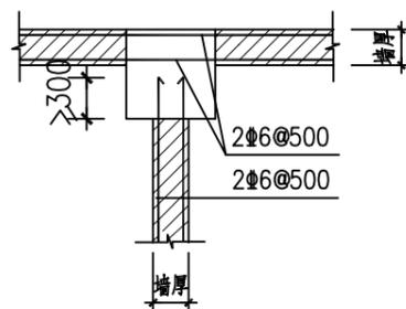
图14.6 结构柱(墙)与砖墙连接
