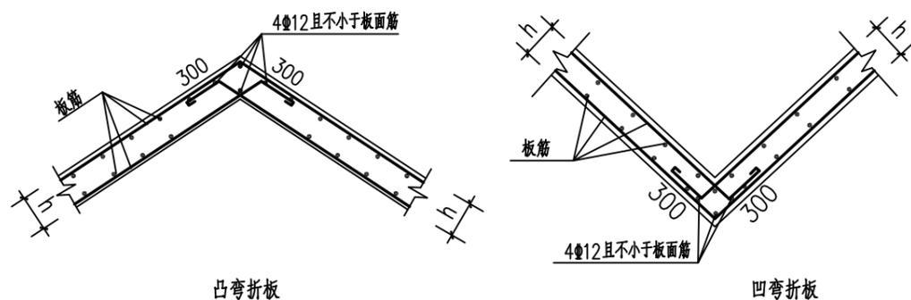
图16.4 凹凸弯折板大样
