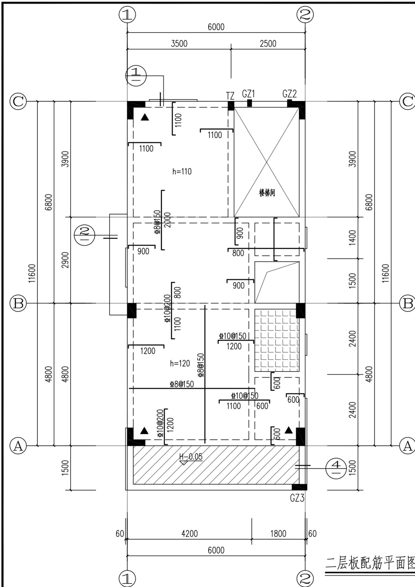
二层板配筋平面图 1:70
