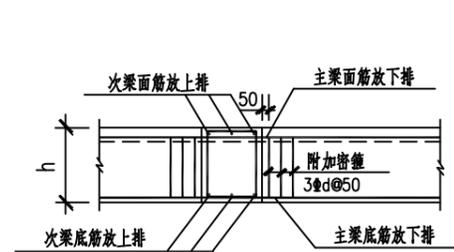
图12.5.5 同高梁纵筋放置大样
