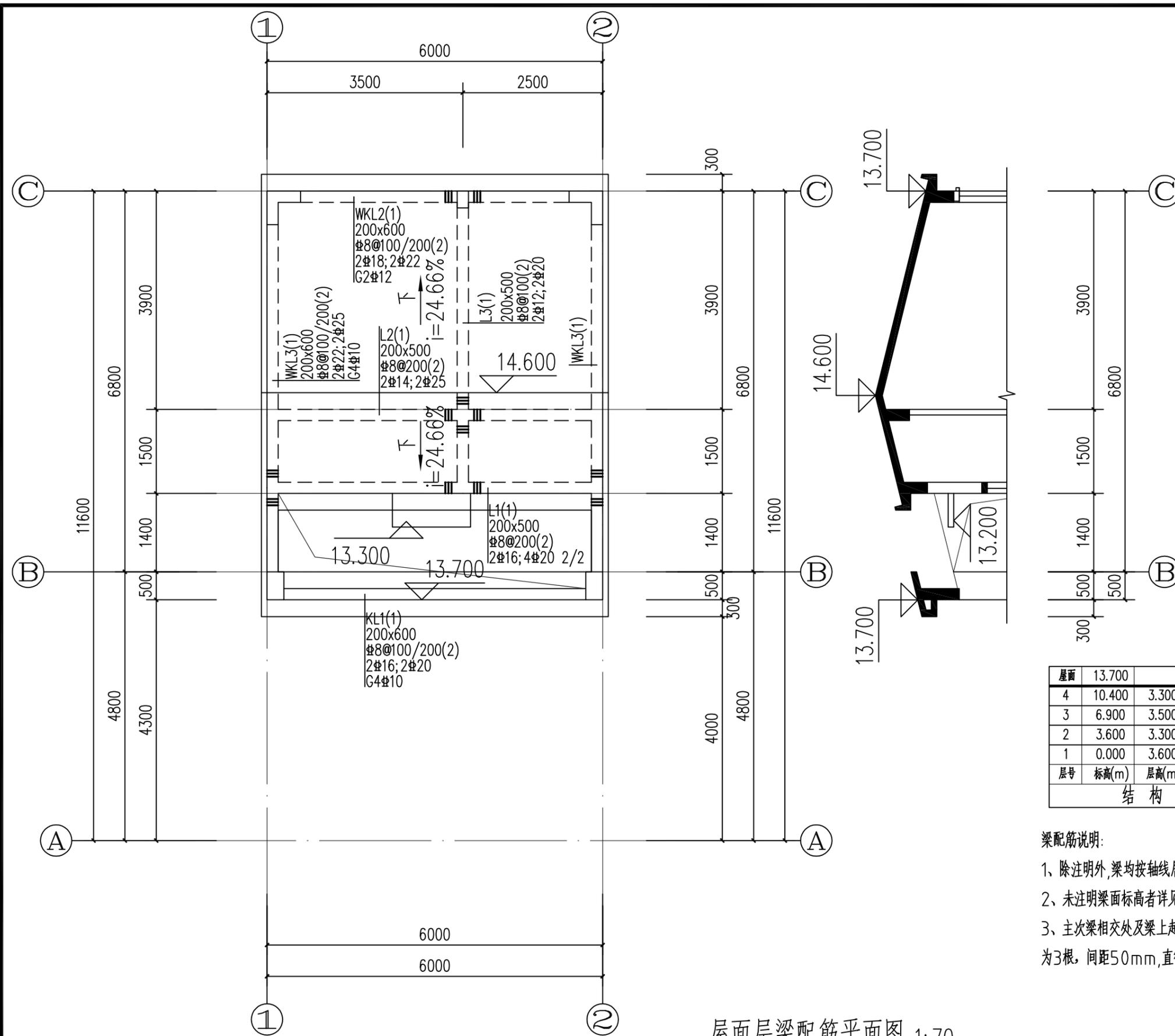
屋面层梁配筋平面图 1:70
