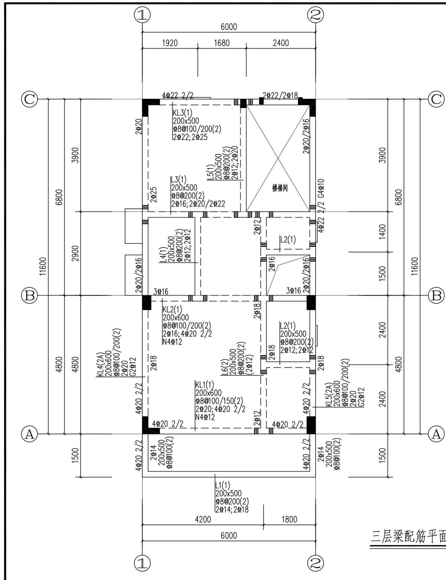
三层梁配筋平面图 1:70
