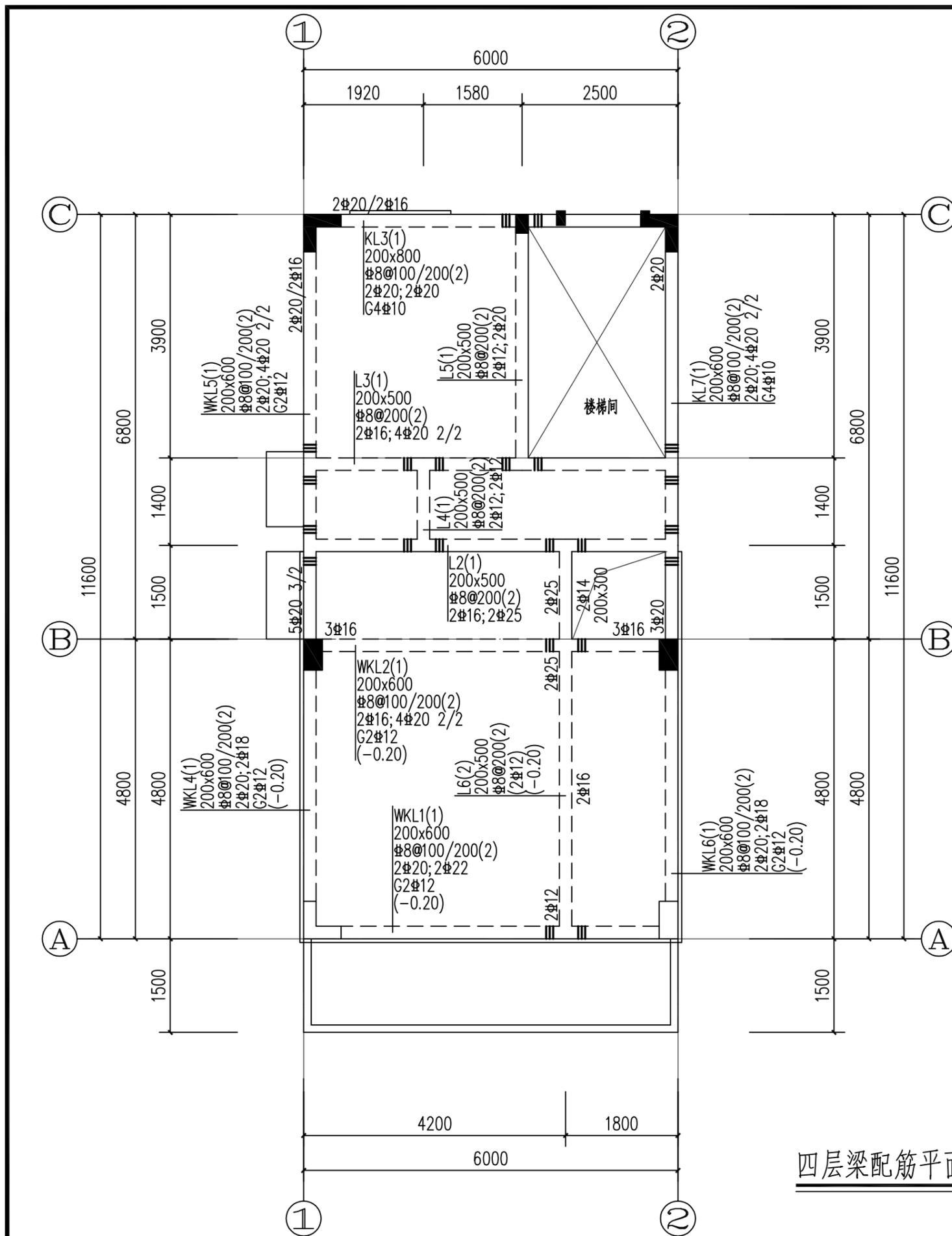
四层梁配筋平面图 1:70
