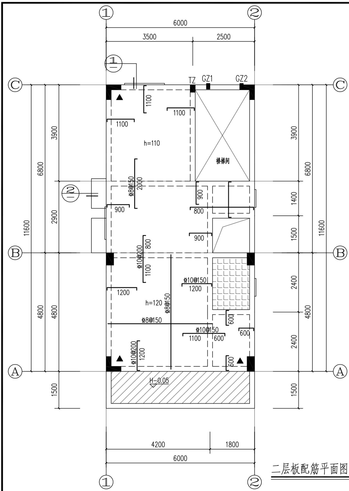
二层板配筋平面图 1:70
