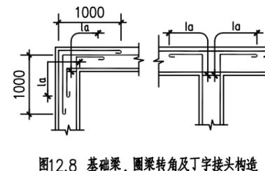
图12.8 基础梁、圈梁转角及丁字接头构造
