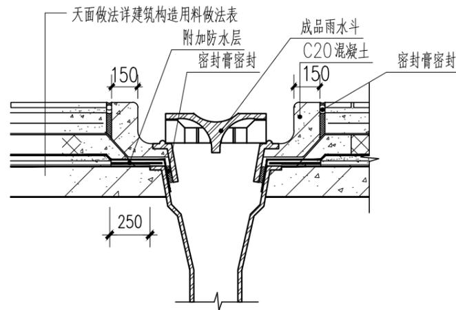
⑥ 雨水口防水构造 1:30
