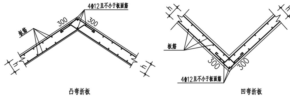
图16.4 凹凸弯折板大样
