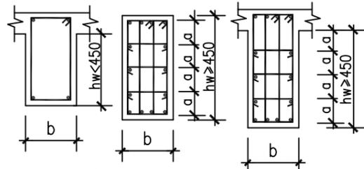
箍筋肢数, 原筋排数见各梁标注配筋
