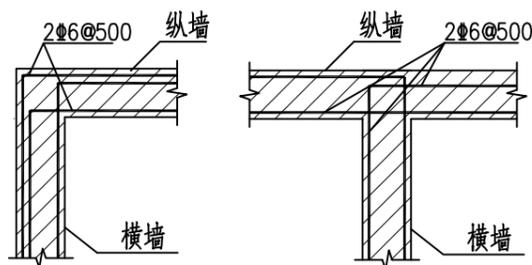
图14.8 纵墙与横墙拉结筋
