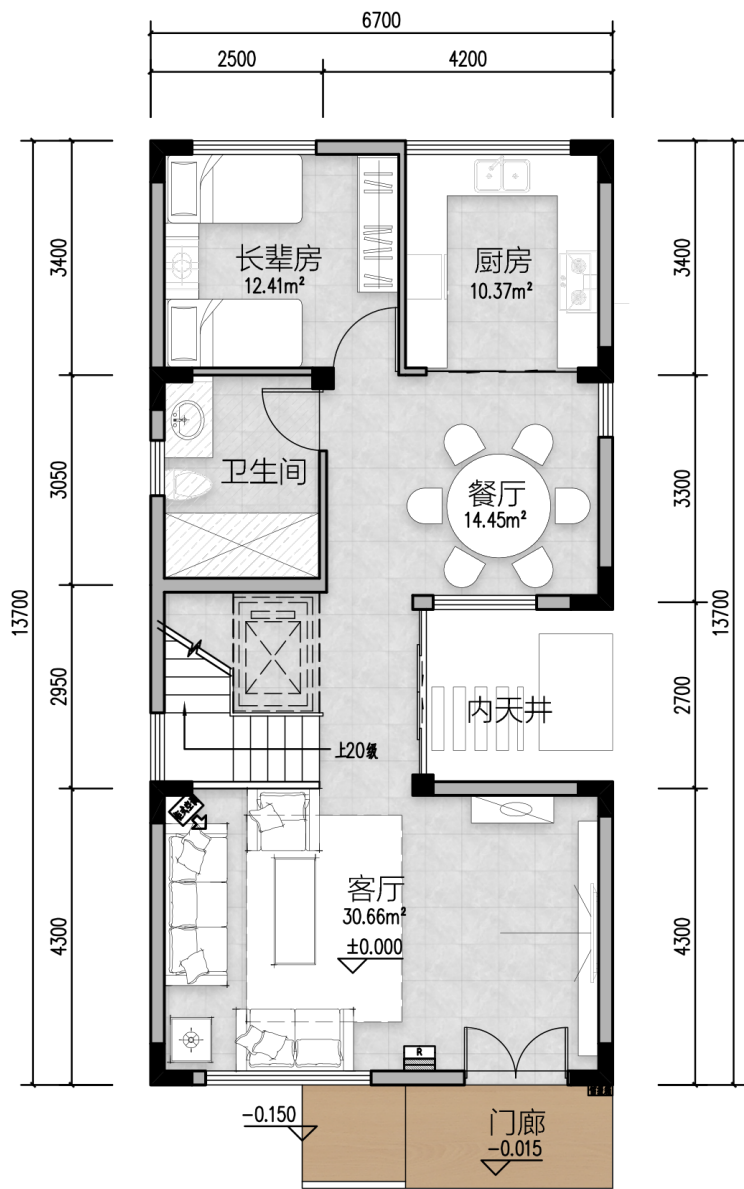
首层平面图 1:80 本层建筑面积: 85.04m 2 总建筑面积: 282.45m 2
