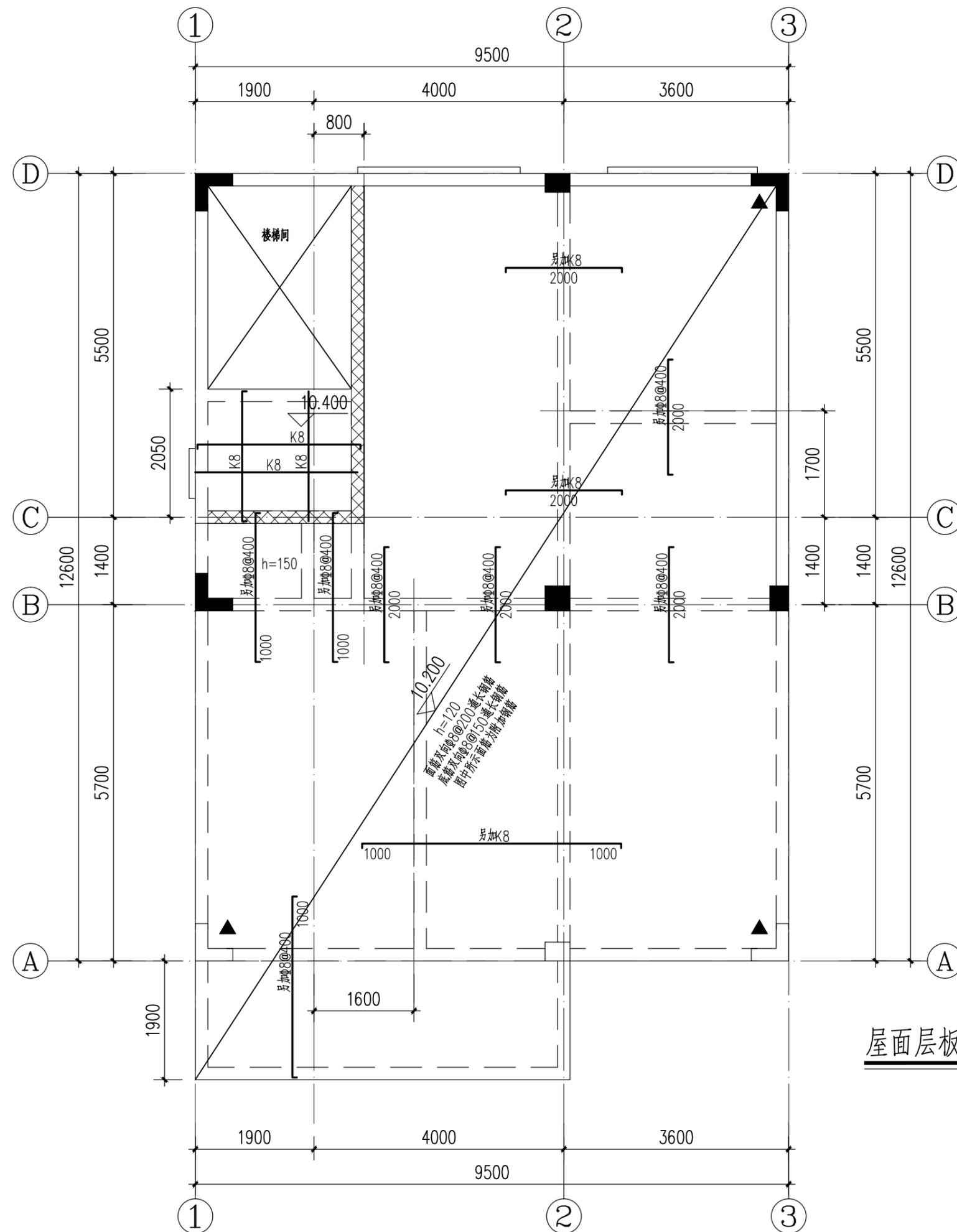
屋面层板配筋平面图 1:70
