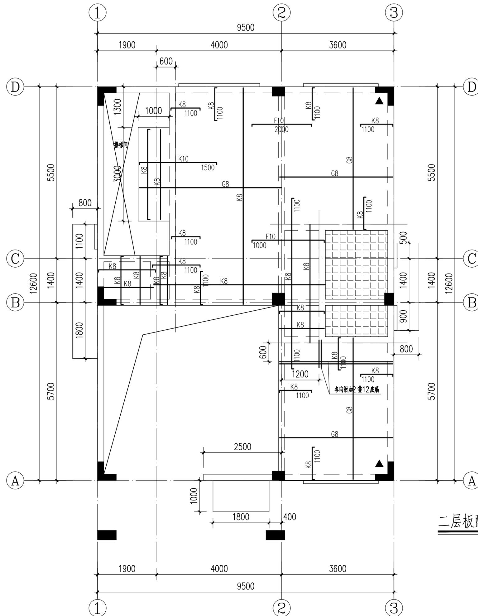
二层板配筋平面图 1:70
