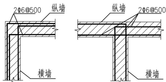
图14.8 纵墙与横墙拉结筋
