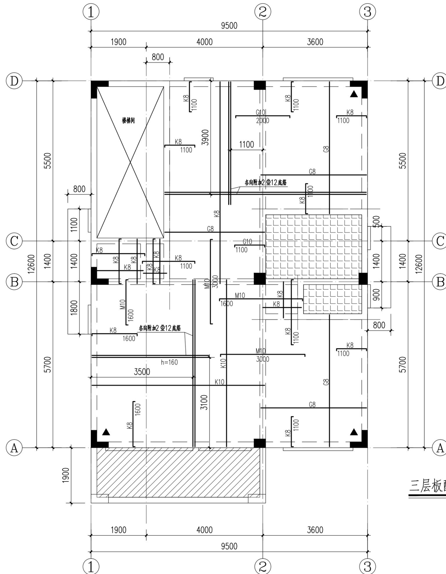
三层板配筋平面图 1:70
