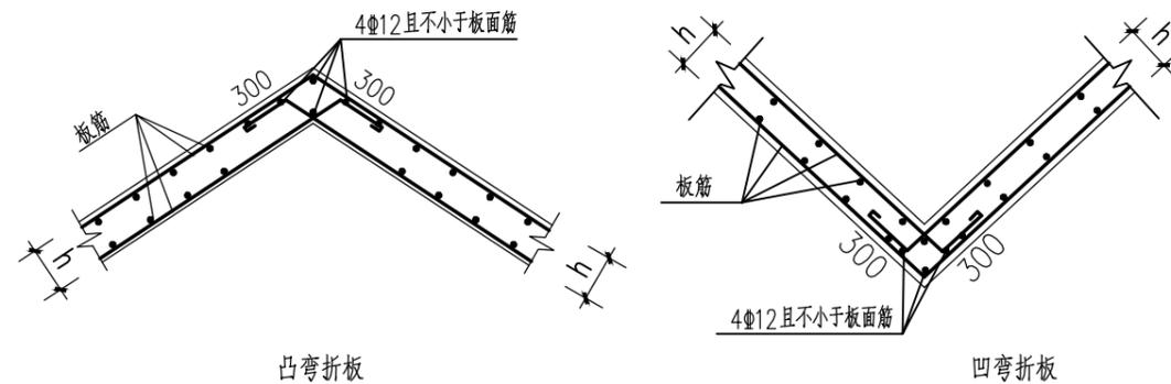
图16.4 凹凸弯折板大样
