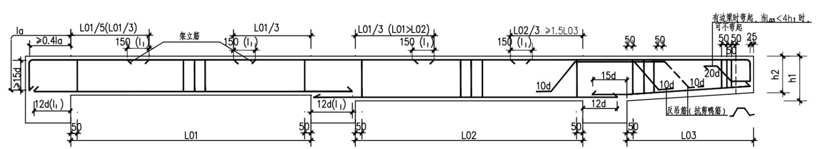
(未注明构造同框架梁, 括号内数字用于弧形非框架梁,  $L$ 为钢筋的搭接长度, 见结构总说明)
