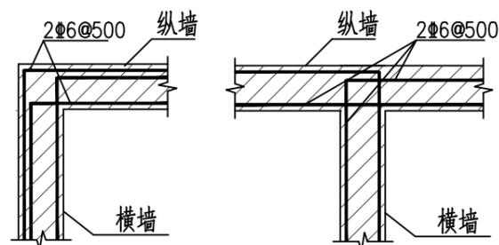
图14.8 纵墙与横墙拉结筋
