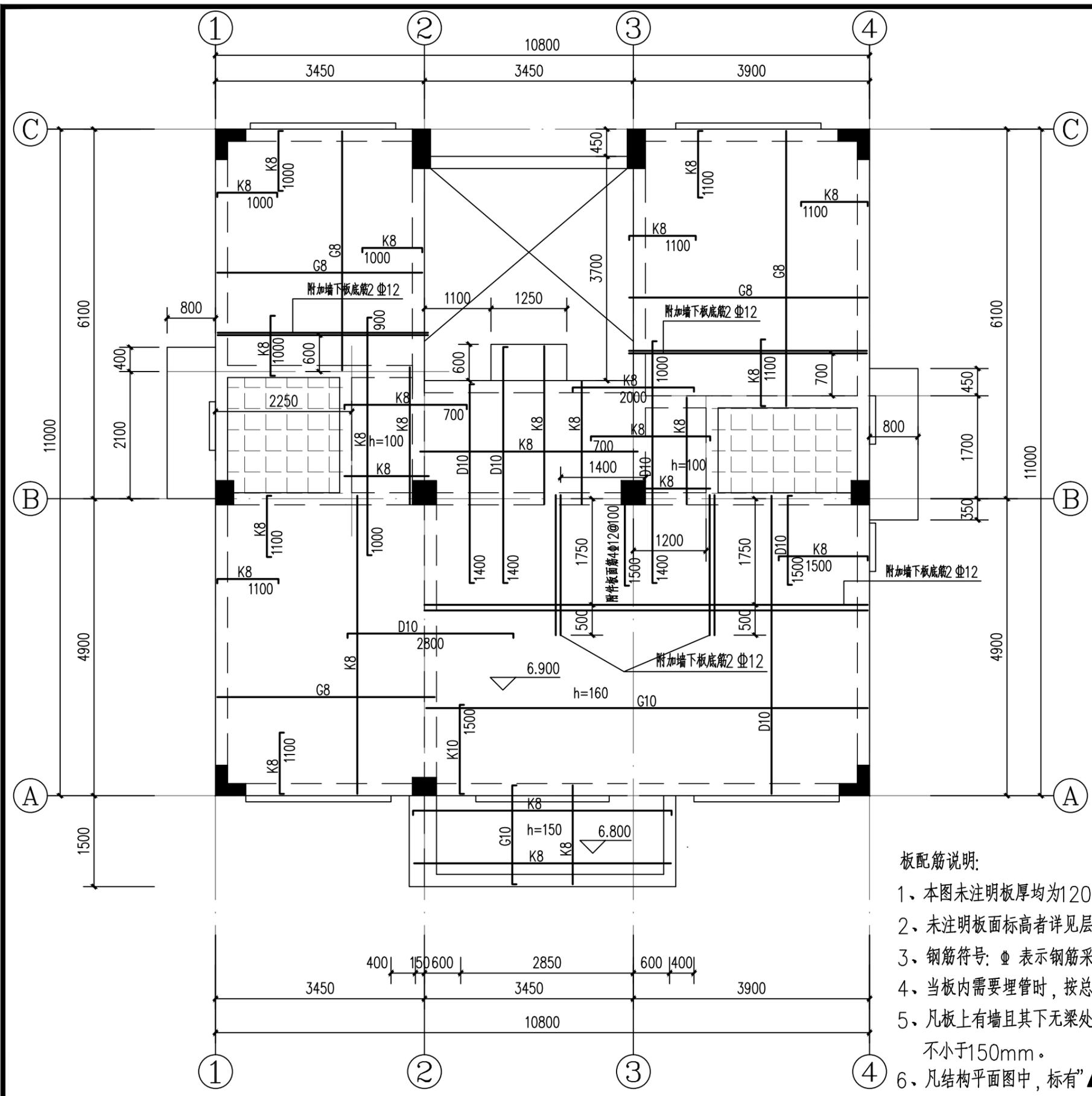
三层板配筋平面图 1:70
