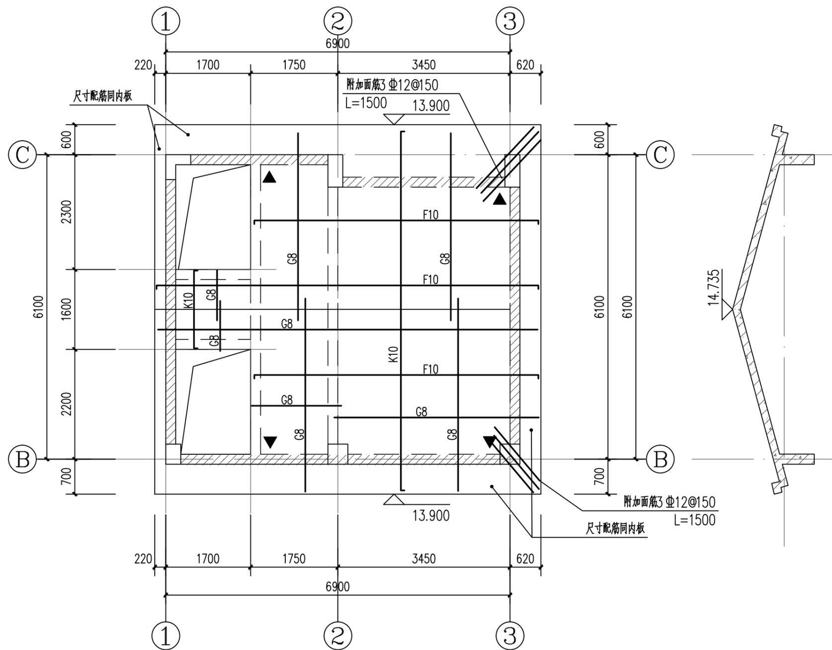
梯屋面层板配筋平面图 1:70
