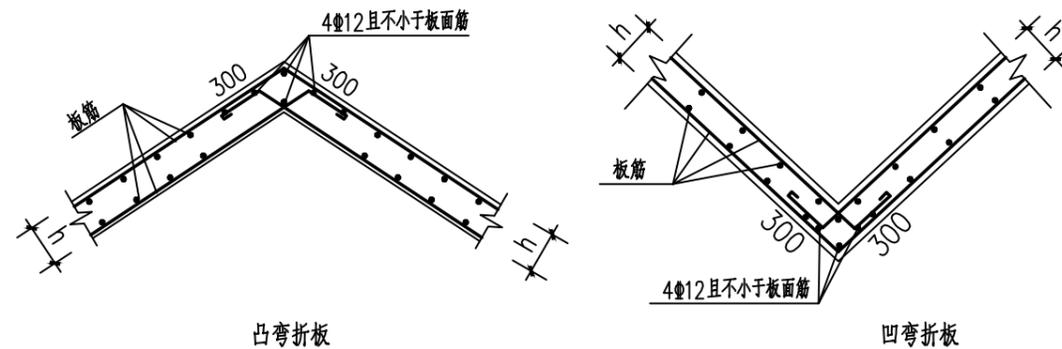
图16.4 凹凸弯折板大样
