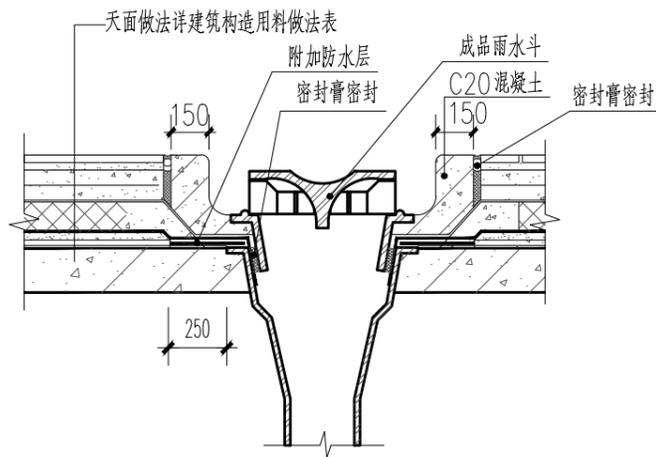
⑥ 雨水口防水构造 1:30
