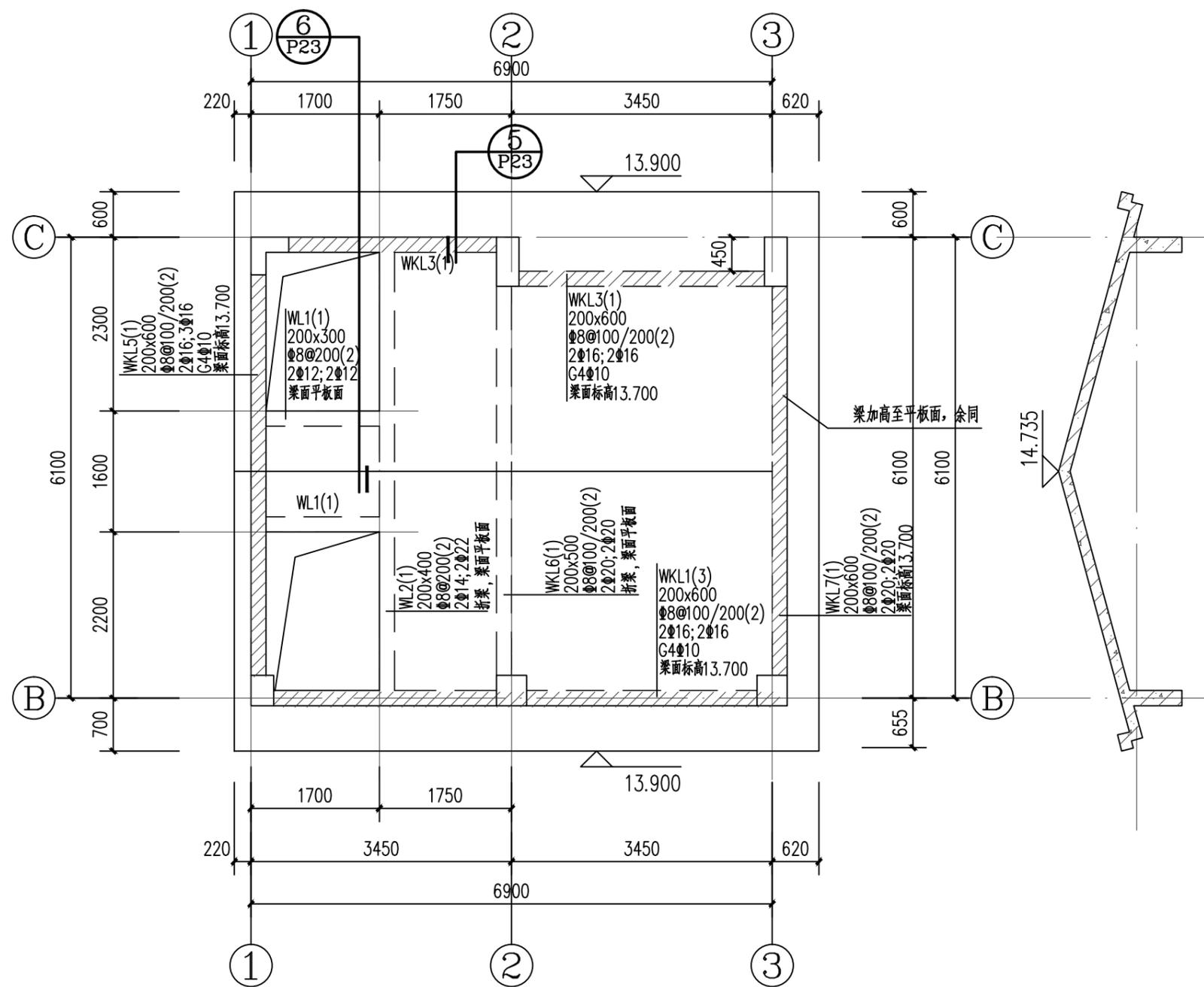
梯屋面层梁配筋平面图 1:70
