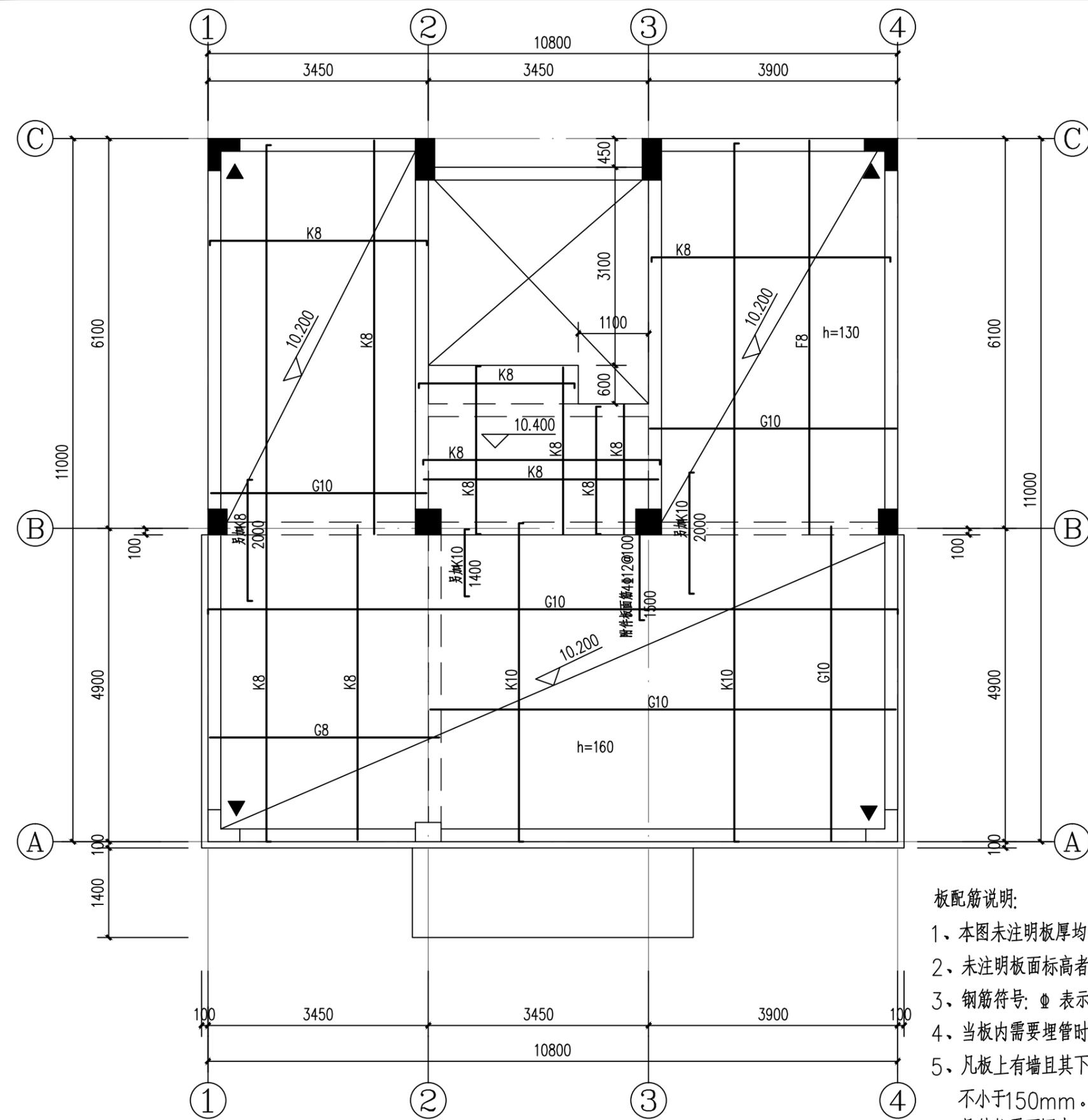
屋面层板配筋平面图 1:70
