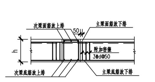
图12.5.5 同高梁纵筋放置大样
