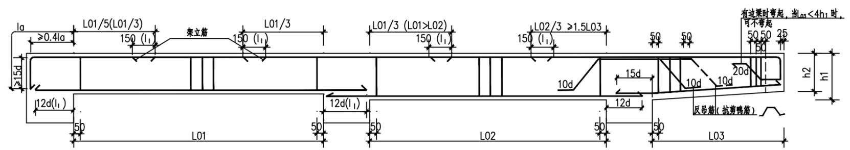
(未注明构造同框架梁, 括号内数字用于弧形非框架梁, L为钢筋的搭接长度, 见结构总说明)
