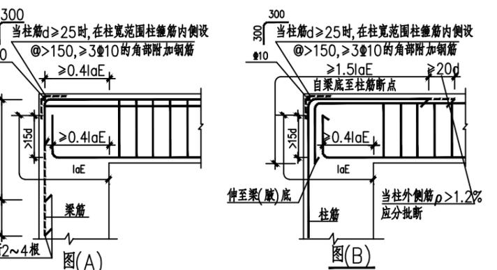
图12.5.8 框架梁(抗震梁)柱顶层端节点构造详图
